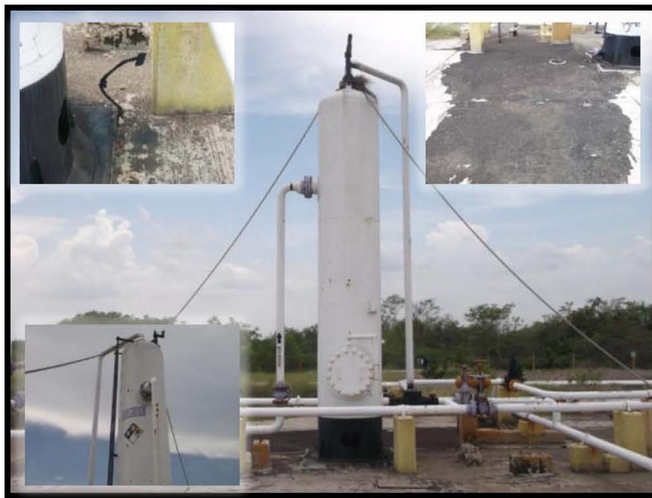
Fotografía 13.- Separador vertical no cuenta con puesta a tierra, Hidrocarburo intemperizado al lado oeste del separador.
