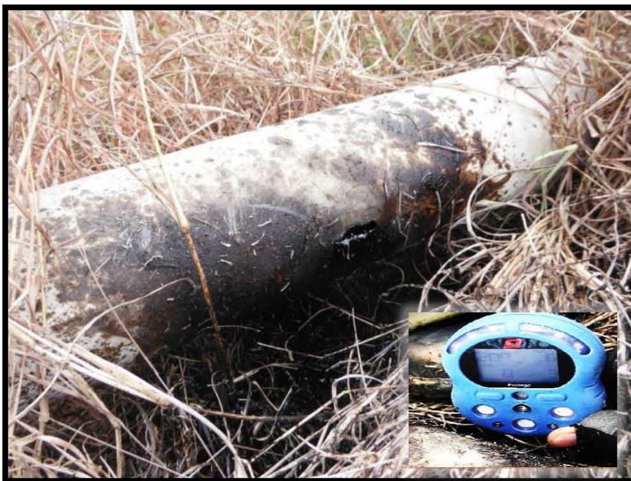
Fotografía 3.- Ruptura de tubería con fuga de hidrocarburo en área de colectores.
