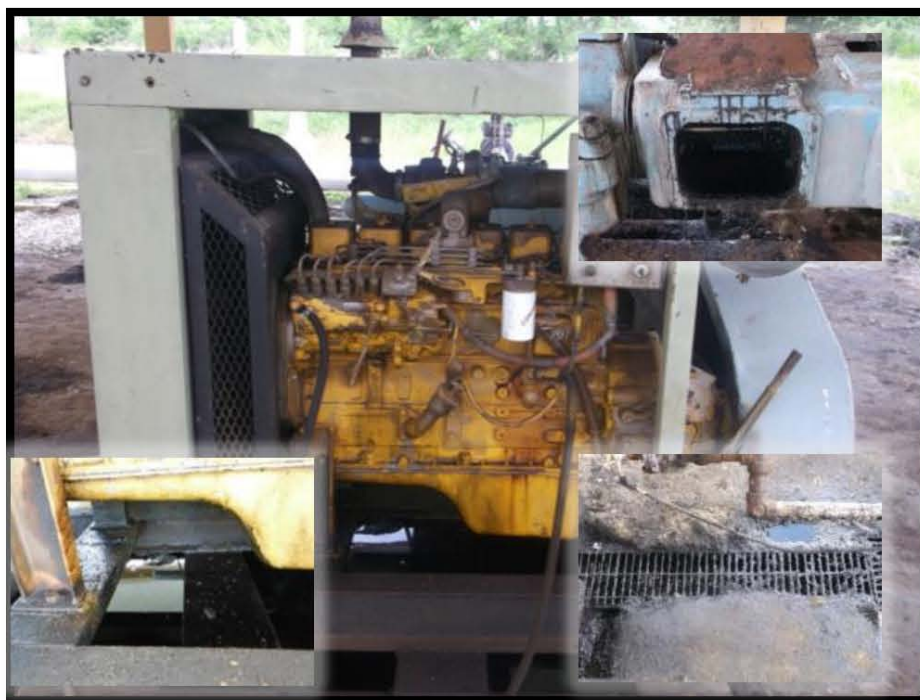
Fotografía 19.- Filtración de aceite proveniente de la bomba de trasiego.
